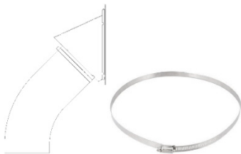
Figura 17 – instalação boca de carga e abraçadeira metálica
