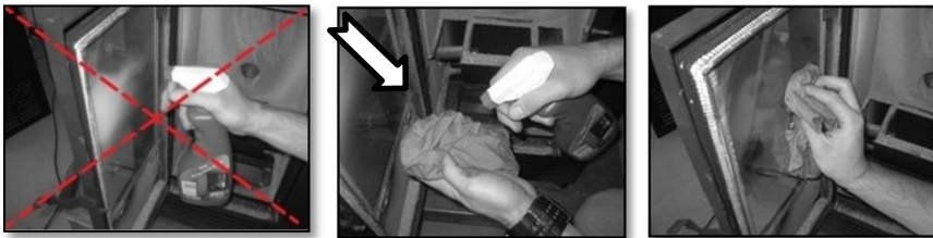
Figura 45 – Exemplificação método de limpeza do vidro
