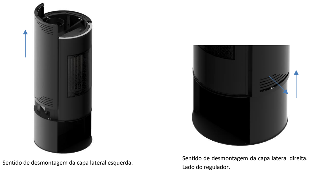
Figura 19 - Desmontagem das capas laterais no equipamento
