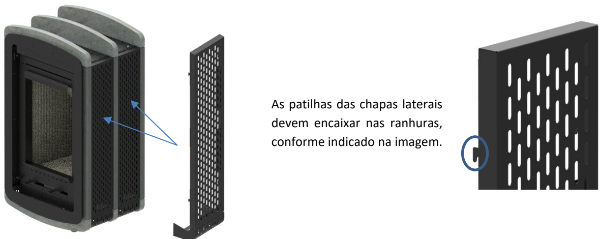
Figura 26 – Montagem das capas de chapa lateral
