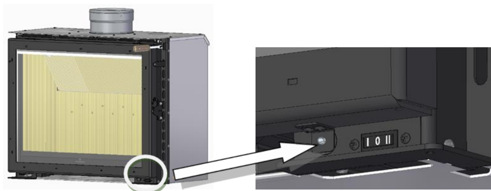
Figure 51 – Réglage de la poignée de porte, fonctionnement par micro-interrupteur
