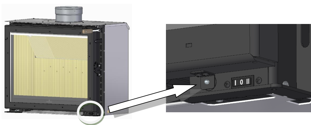
Figura 51 – Ajuste da patilha da porta, acionamento micro-switch
