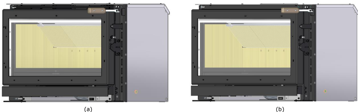
Figura 23 – a) Mecanismo de controlo ar quente do ventilador Aberto, b) Mecanismo de controlo ar quente do ventilador Fechado
