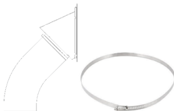
Figura 17 – instalação boca de carga e abraçadeira metálica
