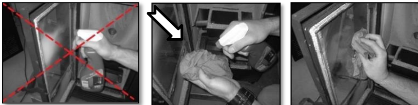
Figura 45 – Exemplificação método de limpeza do vidro
