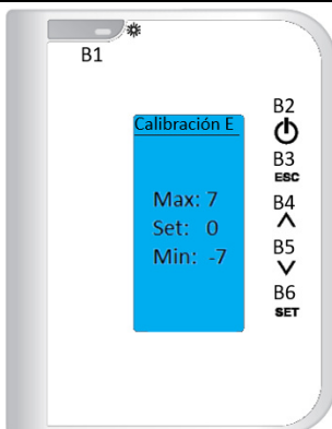
Acceder al Menú Gestión Combustión Calibración Velocidad Extractor
