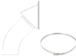
Figura 17 – Instalación boca de carga y abrazadera metálica
