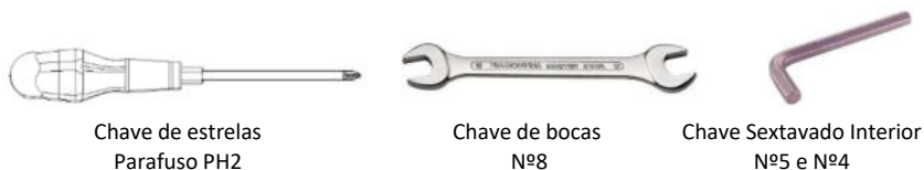
Figura 26 - Material necessário para a instalação das envoltivas
