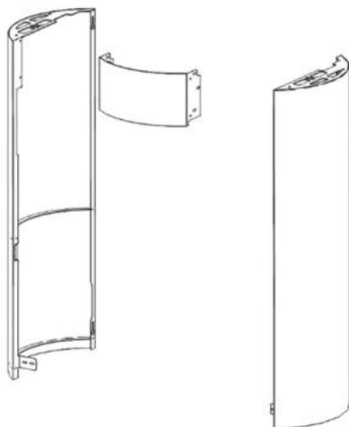
Figura 34 - Material necessário para a instalação das envoltivas
