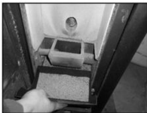
Figura 18 - Limpeza da gaveta de cinzas
