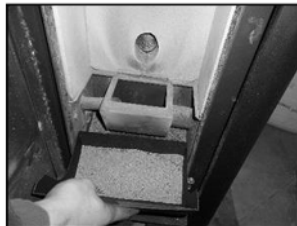
Figura 18 - Limpieza del cestillo de cenizas
