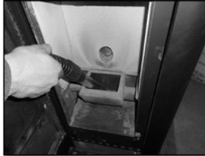
Figura 17 - Limpieza del interior
