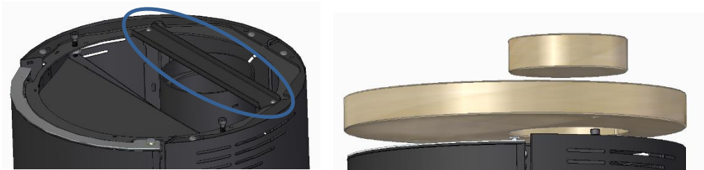
Figura 14 - Colocación de la tapa de piedra en el equipo con salida de humos horizontal
