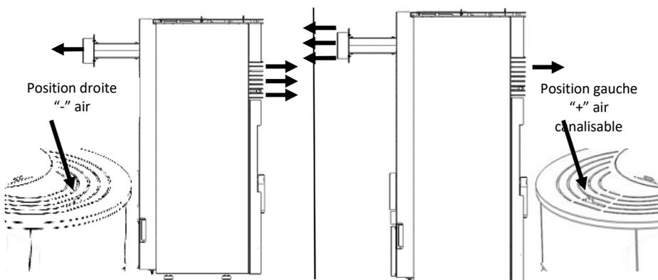
**Figure 62 - Régulation du registre d'air canalisable "+ ou "-"**
