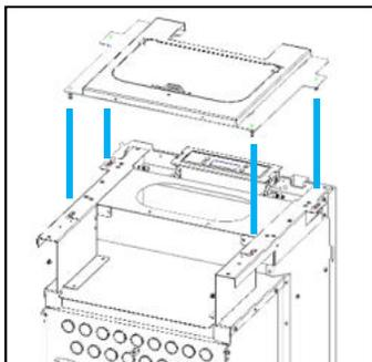
**Figure 27 - Installation du couvercle supérieur**
