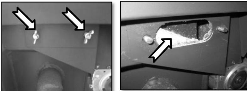
**Figure 21 - Enlever les écrous à oreilles et retirer le couvercle**
