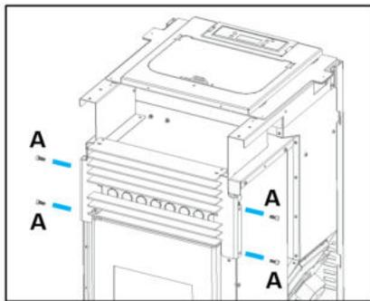
**Figure 28 - Fixation de la grille frontale**
