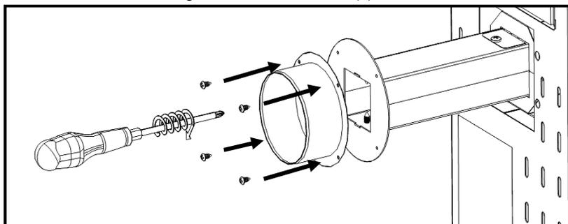
**Figure 55 - Fixation sortie d'air**
