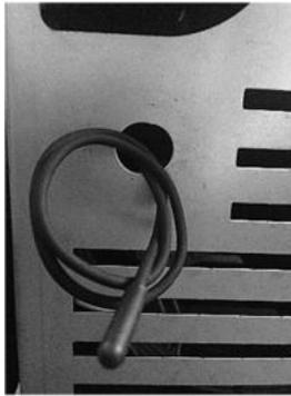
**Figure 12 - Sonde de température ambiante**
