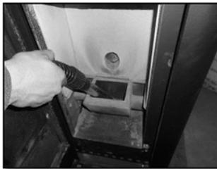
**Figure 17 - Nettoyage intérieur**
