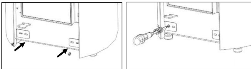
**Figure 43 - Fixation de l'habillage au frontal de finition**
