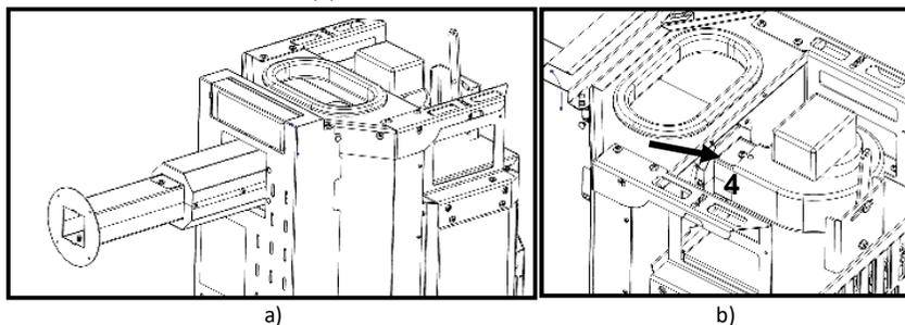
**Figure 53 - Montage guide d'air canalisable**
