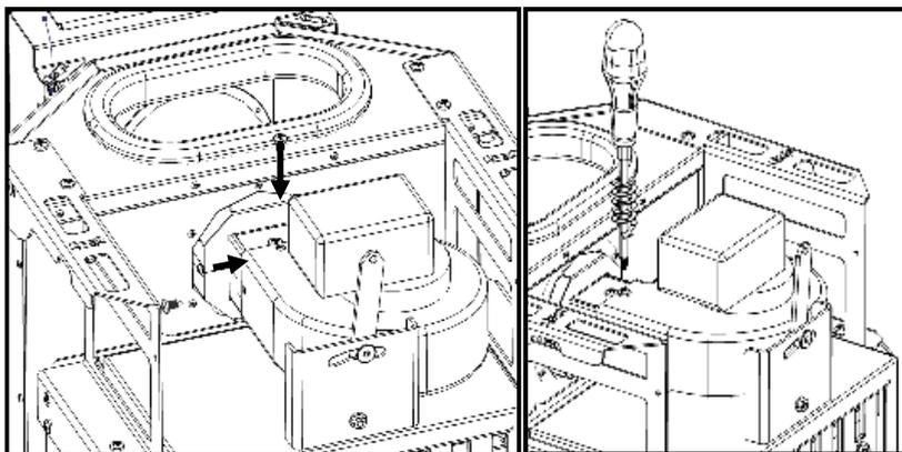
**Figure 54 - Fixation guide d'air canalisable**
