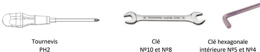
**Figure 26 - Accessoires pour l'installation du kit de ventilation**
