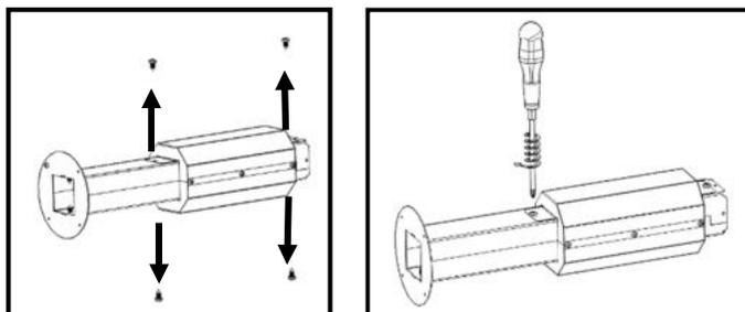
Figure 59 - Démontage de l'isolation thermique
