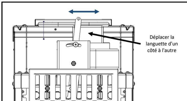
Figure 58 - Vérifiez le verrouillage du registre
