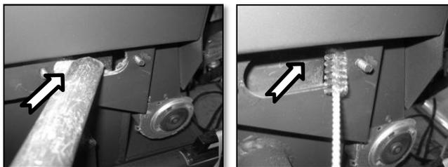
**Figure 22 - Aspirez l'intérieur et nettoyez avec un écouvillon**
