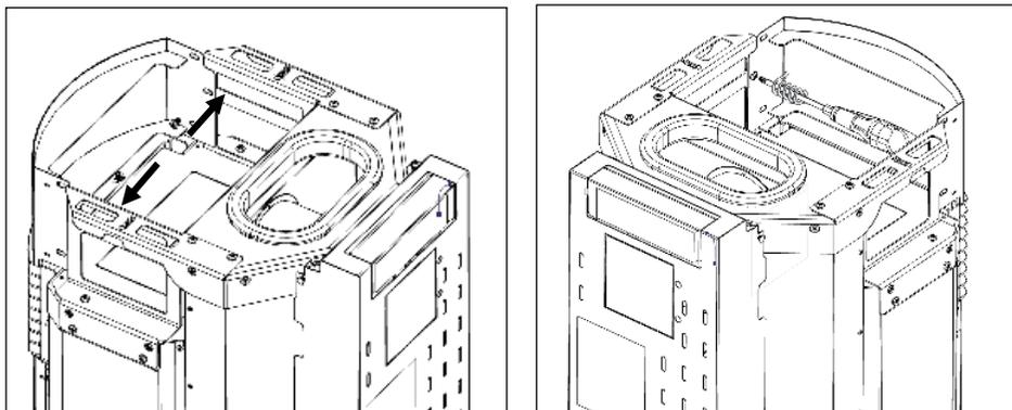
**Figure 37 - Fixation du frontal de finition**
