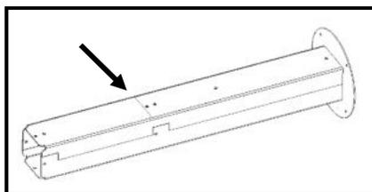
Figure 60 - Zone de découpe du guide d'air canalisable
