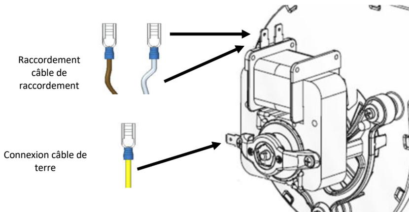
**Figure 57 - Connexion de câblage au ventilateur**
