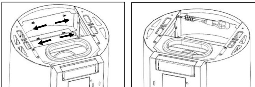
**Figure 42 - Fixation du couvercle au frontal de finition**
