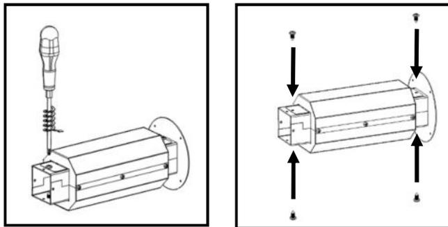
**Figure 61 - Réassemblage de l'isolation thermique**
