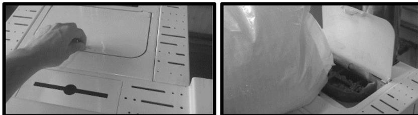
**Figure 9 - Ouverture du couvercle du réservoir à granulés**
