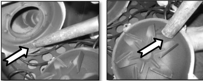
**Figure 24 - Nettoyage de l'extracteur**
