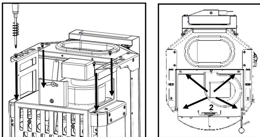
**Figure 51 - Fixation du ventilateur à l'équipement**
