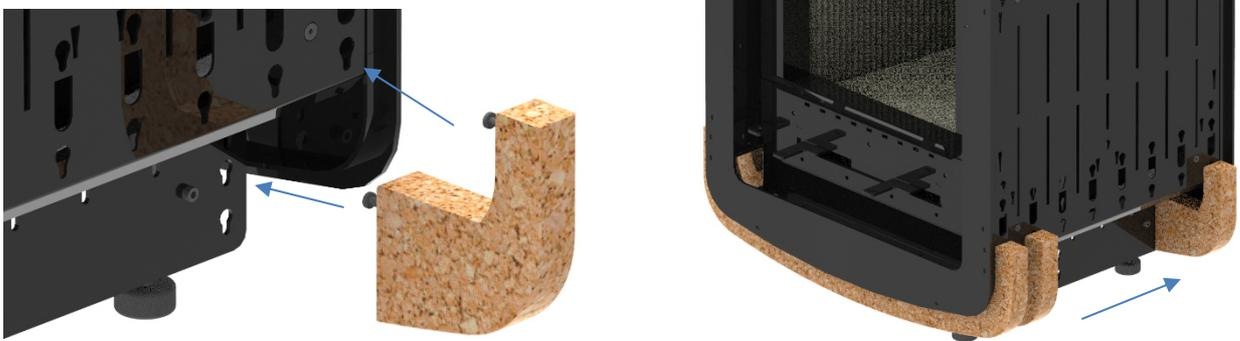
**Figure 16 - Assemblage des parties inférieures sur le poêle**
